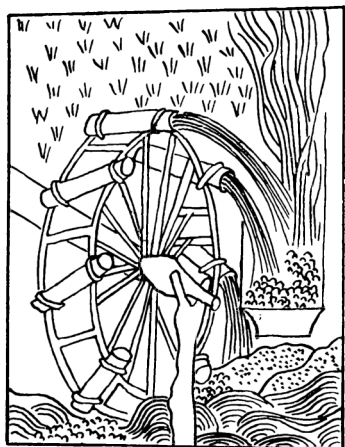
Рис. 29. Водяное колесо. С рисунка XIV в. [Линь Шэн, 1980 (II), с. 15]
